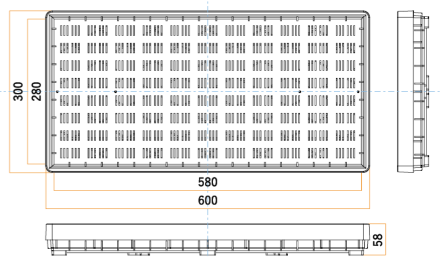
サイズ W600×D300×H58 材質 再生PP(耐候剤入り)
